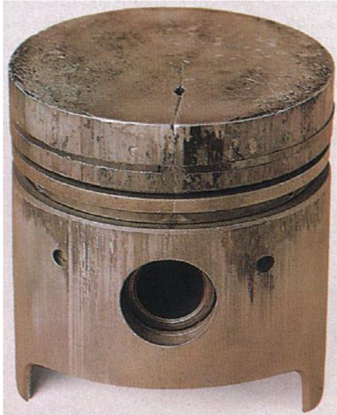
FIGURA 2 – Pistão com Trinca
